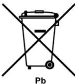
Dieses Symbol weist darauf hin, dass Sie die USV oder die USV-Batterien nicht über die Mülltonne entsorgen dürfen. Dieses Produkt beinhaltet gasdichte Blei-Säure-Batterien und muss ordnungsgemäß entsorgt werden. Für weitere Informationen kontaktieren Sie Ihren örtlichen Recycling-/Wiederverwertungsbetrieb oder den Gefahrenmüllbetrieb.
