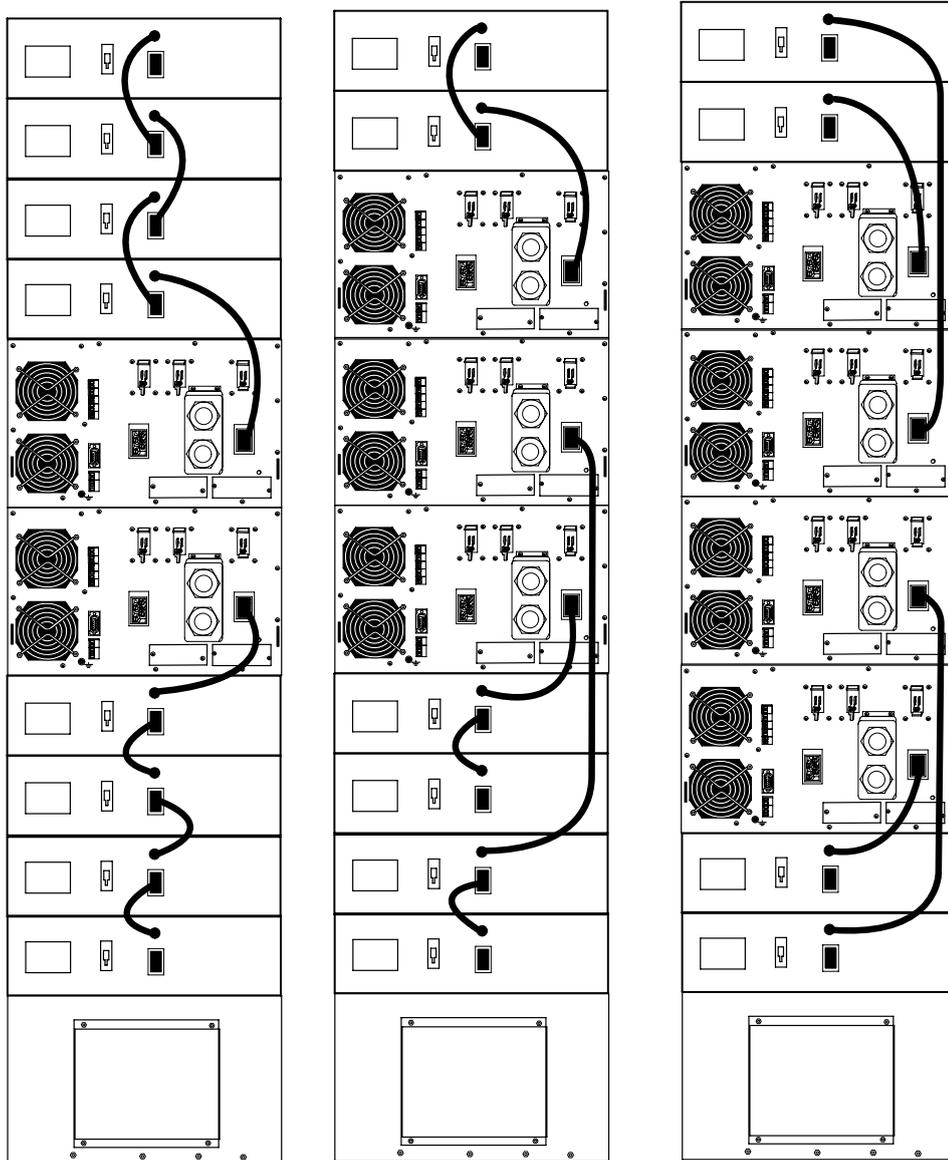
Abbildung 30. Beispiel für eine EBM-Installation in einem Parallelsystem
