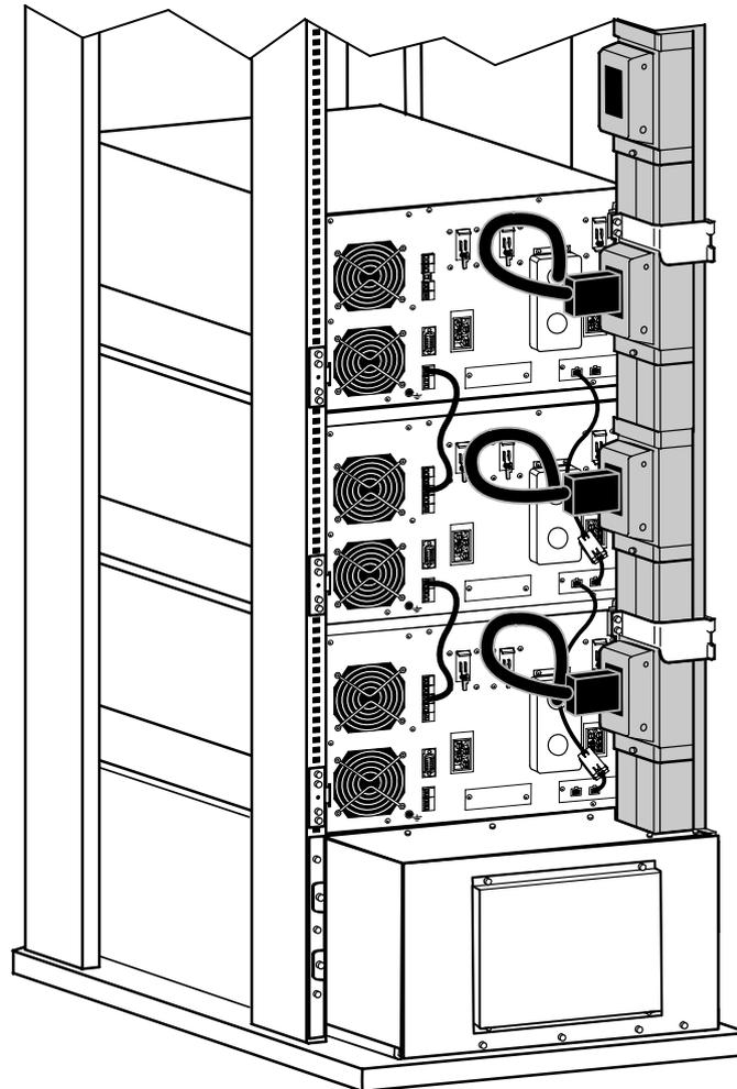
**Abbildung 37. Anschluss der USV an die BladeUPS-Schiene
