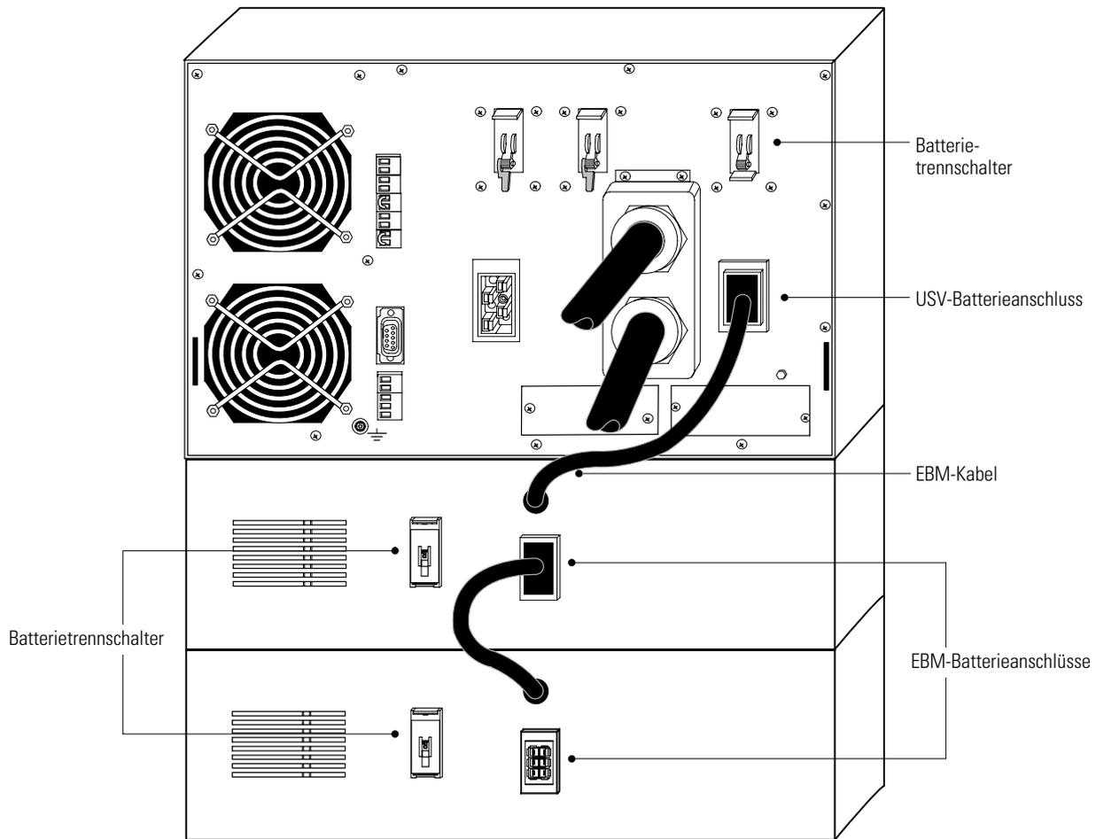
Abbildung 29. Typische EBM-Installation
