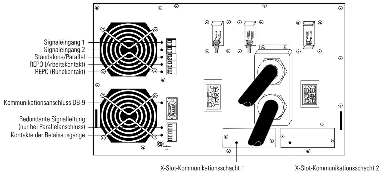
**Abbildung 47. Kommunikationsoptionen und Steueranschlüsse (Standalone-USV)**
