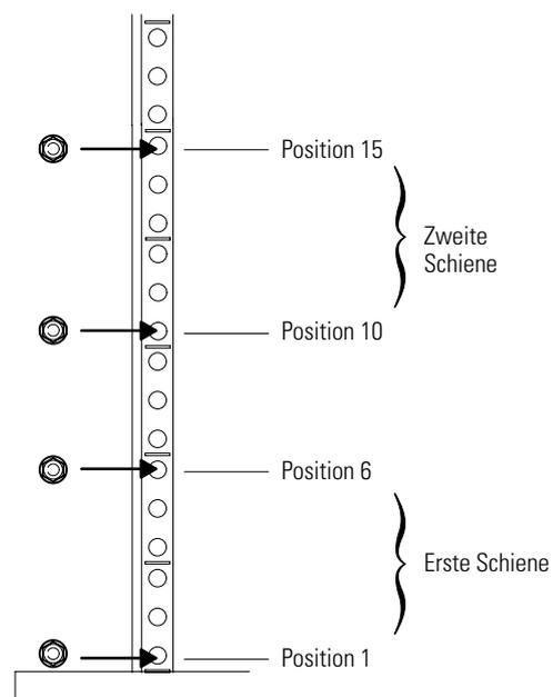
Abbildung 10. Positionen für die vorderen Schienenschrauben des EBM
