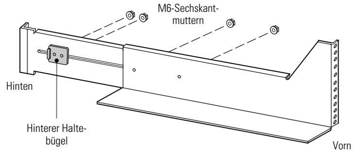
**Abbildung 18. Einbau der Schienenhardware (dargestellt für die rechte Schienenbaugruppe)**
