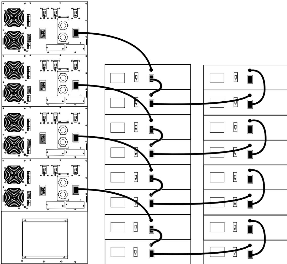
Abbildung 31. Beispiel für eine EBM-Installation in einem großen Parallelsystem
