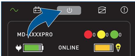
1. Halten Sie den Ausschalter länger als 2 Sekunden gedrückt. Die USV wechselt in den Out-Off-Betrieb.
