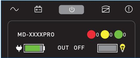
Wenn die USV an die Stromversorgung angeschlossen ist, befindet sich die USV im Out-Off-Betrieb. Im Out-Off-Betrieb werden die Batterien aufgeladen. Der Ausgang ist ausgeschaltet.
